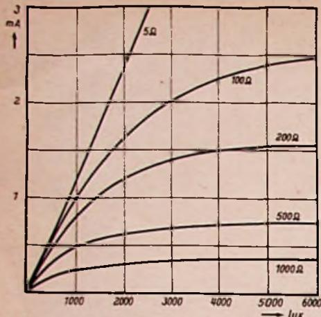
Bild 5. Stromabgabe eines Photoelementes alterer Bauart mit einer wirksamen Fläche von 11,1 cm<sup>2</sup> bei verschiedenen Belastungswiderständen
