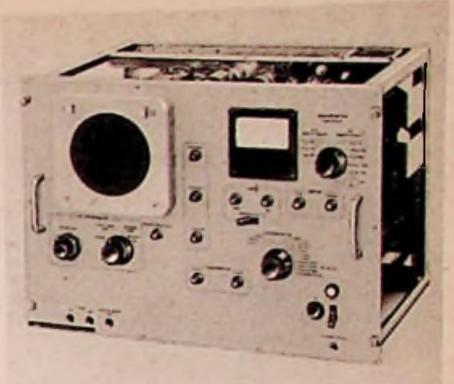
Teil des Siemens-Fernsehmeßgestells: der Fernseh-Kontrolloszillograf 3 U 124
