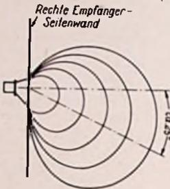
Bild 3. Strahlungsdiagramm des exzentrischen Spezial-Seitenlautsprechers von Isophon
