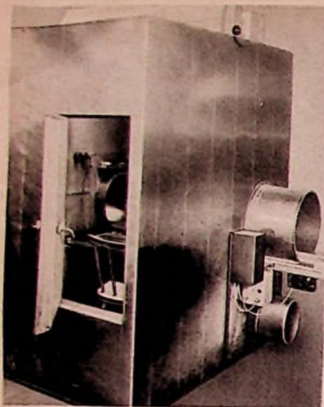
Abschirmk $\ddot{u}$ fig MGL 4100 von Grundig. Die  $\ddot{O}$ ffnungen zum Einsteigen, zum Durchschieben der Ger $\ddot{a}$ te und zur Bet $\ddot{u}$ ftung sind vollkommen st $\ddot{o}$ rsicher
