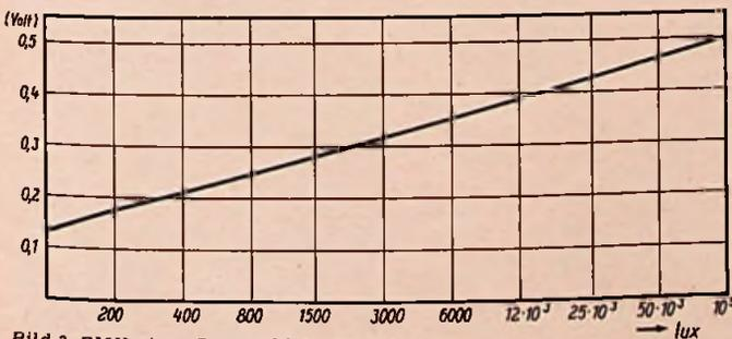
Bild 3. EMK eines Sperrschicht-Fotoelementes
