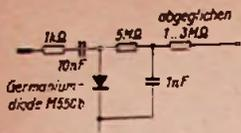
Bild 3. Schaltung des Tastkopfes
