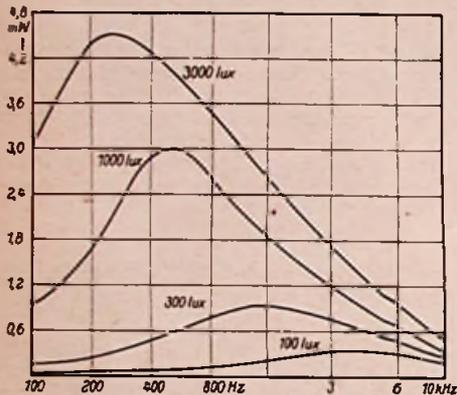
Bild 6. Elektrische Leistung einer Electrocell-Lichtelement-Batterie der Größe 300 cm<sup>2</sup> in Abhängigkeit vom Lastwiderstand bei kleinen Beleuchtungsstärken. Das Leistungsmaximum verschiebt sich mit wachsender Beleuchtungsstärke zu kleineren Lastwiderstandswerten. Man erkennt an den Kurven, wie stark die Leistung absinkt, wenn falsch angepaßt wird
