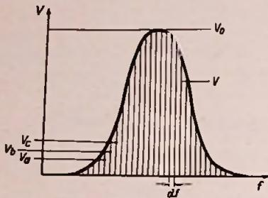
Bild 1. Skizze zur Bestimmung der effektiven Bandbreite
