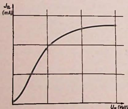
Bild 2.  $I_a U_a$ -Kennlinienfeld einer Rauschdiode mit Sättigungscharakter
