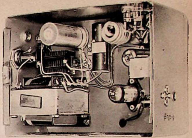
Bild 1a. Blick auf das in den Gehäuserahmen eingebaute Chassis. Rechts oben neben den Ausgangsbuchsen der schraubenförmig aufgewickelte Impedanz-Transformator
