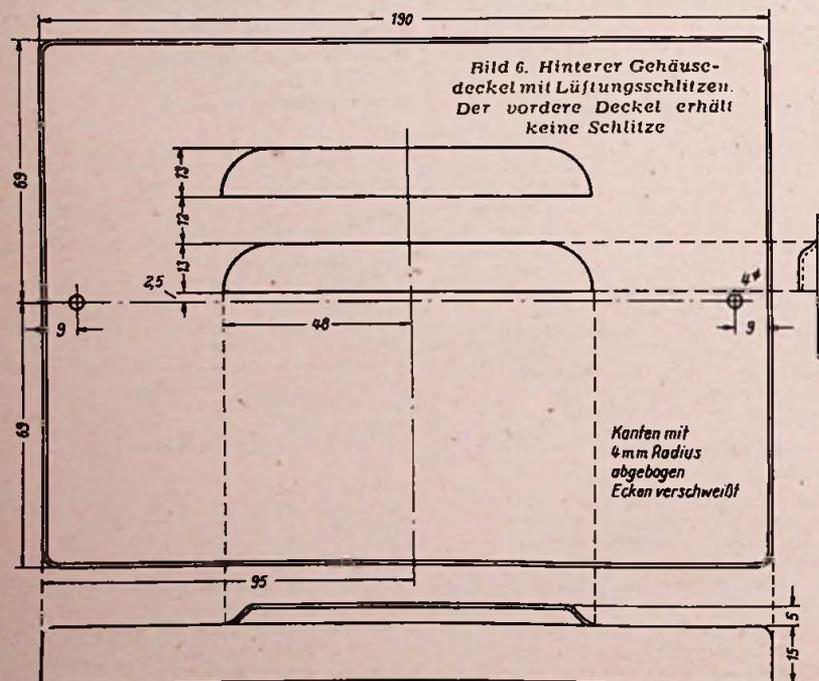
Bild 6. Hinterer Gehäusedeckel mit Lüftungsschlitzen. Der vordere Deckel erhält keine Schlitze
