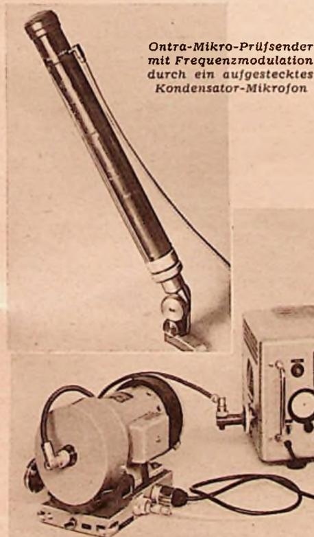
Ontra-Mikro-Prüfsender mit Frequenzmodulation durch ein aufgestecktes Kondensator-Mikrofon
