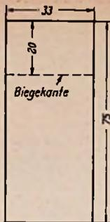
Bild 8. Zuschnitt für die beiden Abschirmbleche
