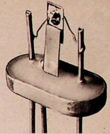
Bild 1. So einfach sieht ein neuerzeitlicher Flächen transistor in starker Vergrößerung aus, und doch ist hierüber eine ganze neue Wissenschaft entstanden (SAF-Transistor ohne Kappe)
