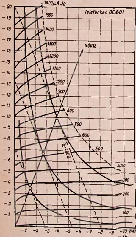
Bild 7. Konstruktion des Arbeitspunktes für die Endstufe im Kennlinienfeld eines Transistors OC 601 in Emitterschaltung
