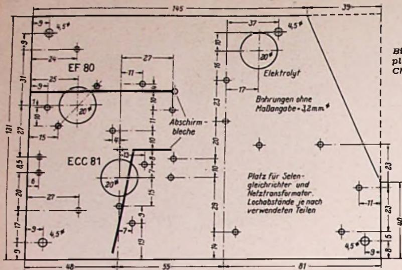
Bild 4. Bohrplan für das Chassisblech
