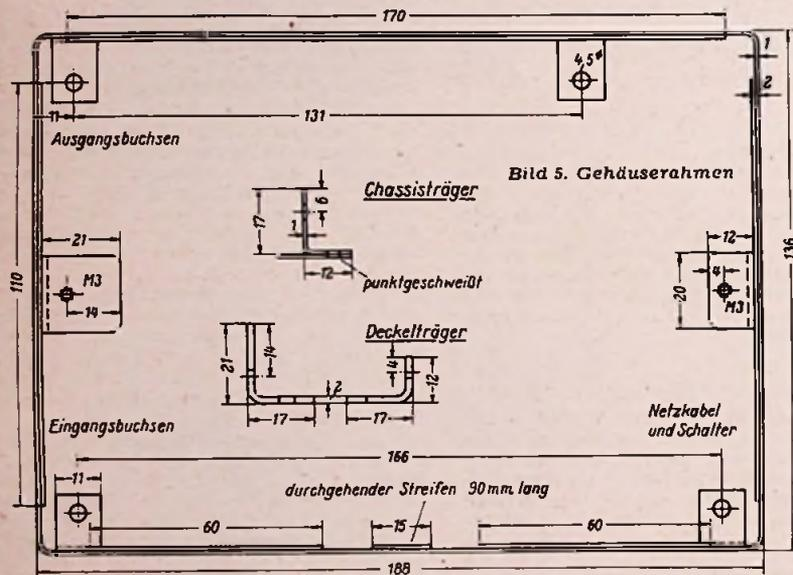
Bild 5. Gehäuserahmen
