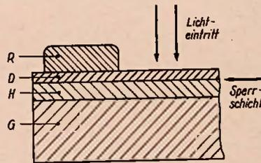
Bild 2. Grundsätzlicher Aufbau eines Sperrschicht-Fotoelementes nach Falkenthal. G = Grundplatte, H = kristalline Halbleiterschicht (Selen), D = Deck-Elektrode, R = aufgespritzter Metallrand. Zwischen H und D liegt die Sperrschicht
