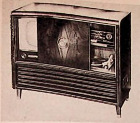
Grundig-Dreierkombination 870/3 D. Die Schiebetür öffnet entweder den Rundfunk- und Phonteil oder den Bildschirm sichtbar werden
