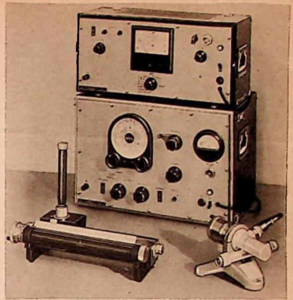
Dämpfungsmeßplatz für 300...1000 Hz mit dem Siemens-Meßsender 3 W 58
