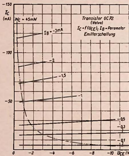
Bild 4. Kennlinienfeld für den Valvo-Transistor OC 72 in Emitterschaltung
