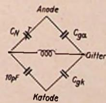
Bild 3. Neutralisierung der Eingangsschaltung
