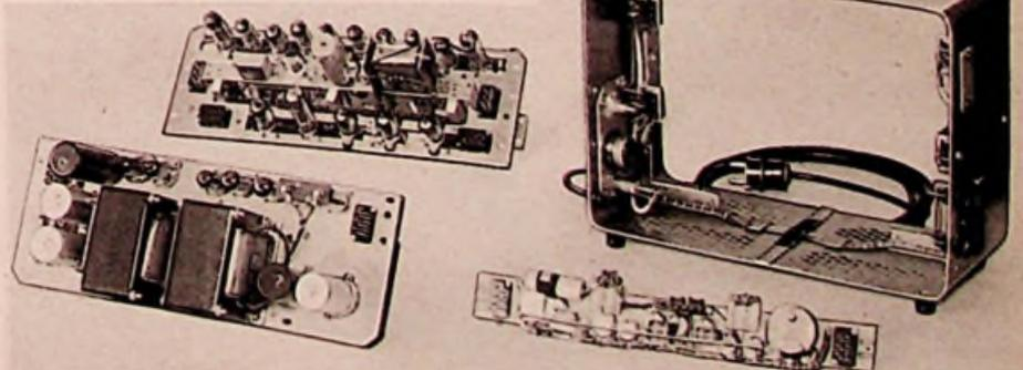
Bausteine des Steuergerätes zum Grundig-„Fernauge“; von links: Netzteil, Impuls- und Verstärkerteil, Reglerleiste und Gehäusemantel mit Verkabelung
