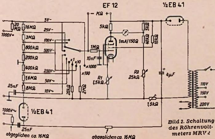
Bild 2. Schaltung des Röhrenvoltmeters MRV 2
