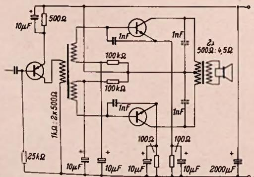
Bild 8. Gegentakt-B-Stufe mit zwei npn-Flächentransistoren für niedrige Betriebsspannung
