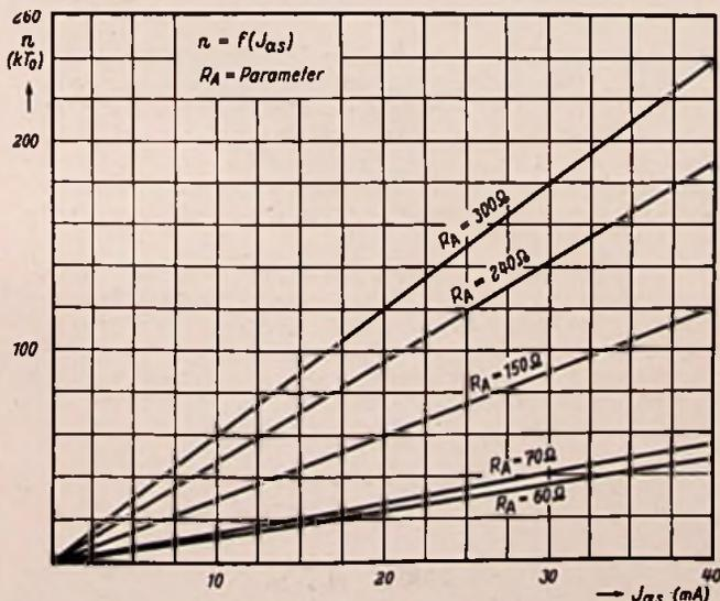
Bild 5.  $n = f(I_{as})$ ;  $R_A =$  Parameter, Empfängereingang an  $R_A$  angepaßt
