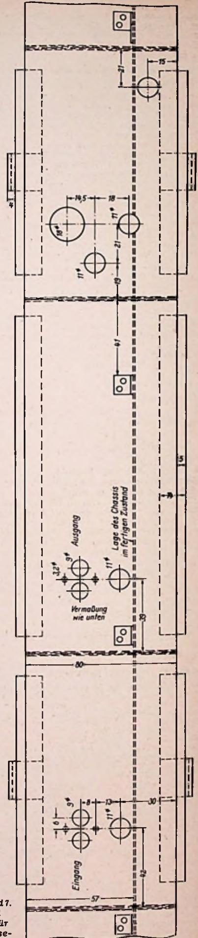
Rechts: Bild 7. Maße und Bohrplan für den Gehäuserahmen
