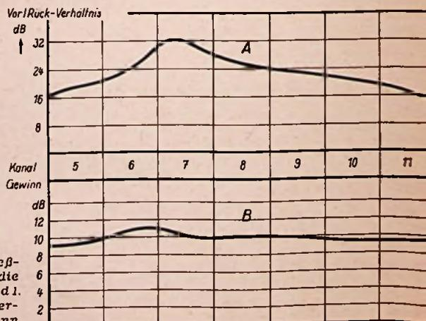
Rechts: Bild 5. Meßergebnisse für die Antenne nach Bild 1. A = Vor/Rück-Verhältnis; B = Gewinn
