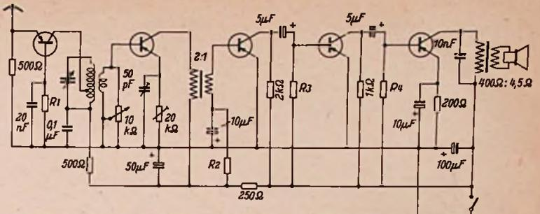
Bild 9. Schaltung des Cellophon II. Die Widerstände R<sub>1</sub> bis R<sub>4</sub> sind vom Transistor-Exemplar stark abhängig, sie sind so zu wählen, daß die aus dem Kennlinienfeld bestimmten Arbeitspunkte eingenommen werden
