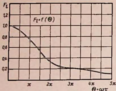
Bild 6. Berücksichtigung der Elektronenlaufzeit in der Rauschformel
