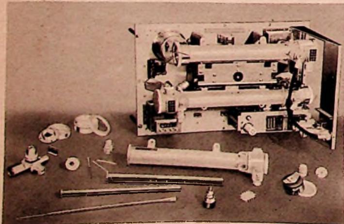
Innenansicht eines noch nicht fertig montierten Siemens-Meßsenders 3 W 58 mit rohrförmigen koaxialen Abstimmkreisen
