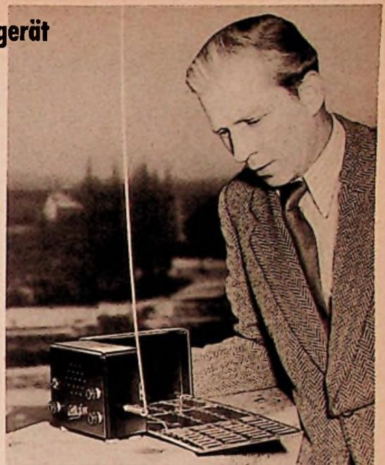
O. Faust mit dem von ihm konstruierten lichtbetriebenen Transistor-Empfänger (Foto: dpa)
