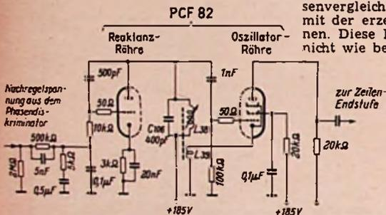
Schaltung des Zeilenoszillators beim Nora-Fernsehempfänger F 11
